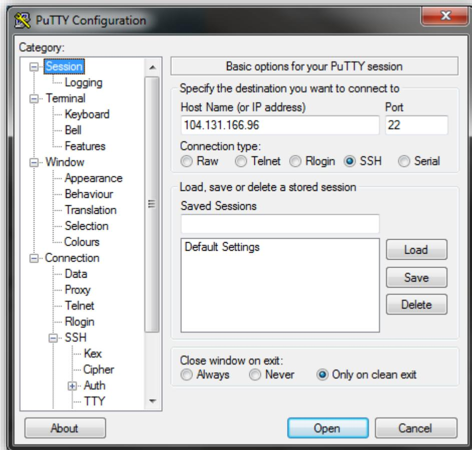
13. Abrir la conexión con el botón Open, en la pantalla de terminal que aparece colocar el usuario root y la clave proporcionada, se obtendrá acceso a la máquina del VPS.
